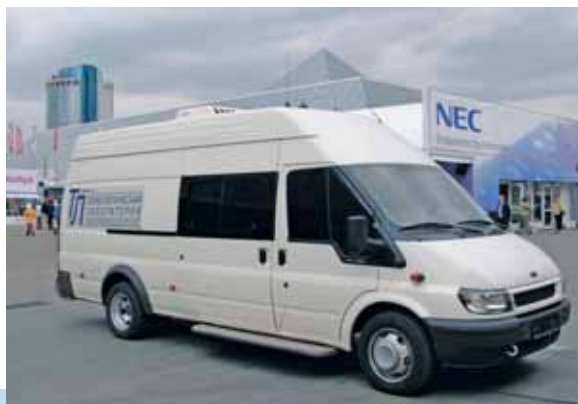
Мобильный пункт управления и связи на базе микроавтобуса «Форд-Транзит»
