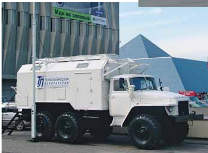
Мобильный узел связи на базе полноприводного автомобиля повышенной проходимости «Урал»
