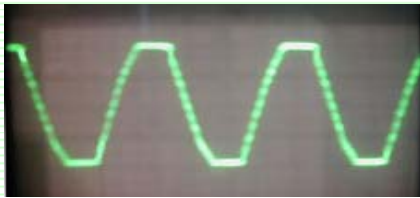
Рис. 3 Осциллограмма фазного напряжения при S=12
