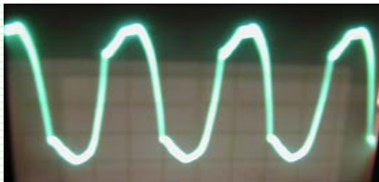
Рис. 4 Осциллограмма тока в нулевом проводе при S=12 кВА
