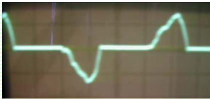
Рис. 2 Осциллограмма фазного тока при S=12 кВА
