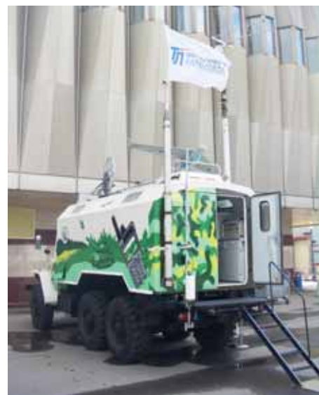
Рис. 1. Мобильный комплекс управления, связи и видеомониторинга
